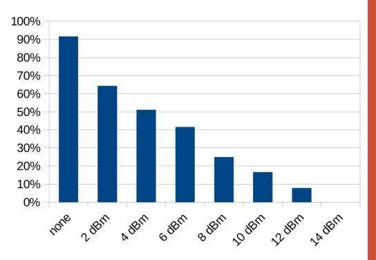
COMBINED SYSTEM SUCCESS RESULTS, TEST 1, GENERATION OF LORAWAN INTERFERENCE
